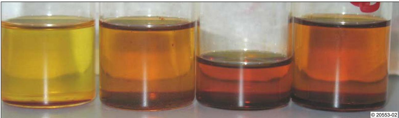
A1: Veränderung von reinem Biodiesel durch Lagerung bei 50 °C. Oxydierte Kraftstoffanteile färben den Biodiesel dunkel.
